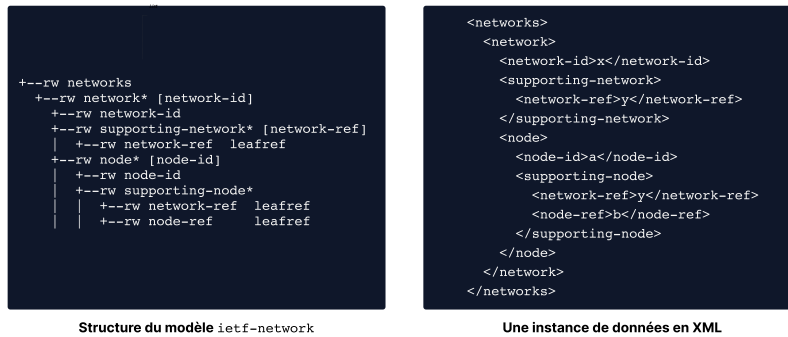
Fig. 3: Utilisation du modèle ietf-network pour représenter la topologie d'un réseau. (a) La représentation du modèle sous forme d'arbre. (b) Son utilisation pour la représentation d'une instance particulière (ici en XML).
